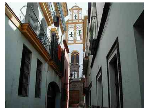
Fig. 1. 2 – Casas blancas en calles estrechas situadas en el barrio Santa Cruz de Sevilla. Estas son dos de las muchas estrategias que se usaban en la arquitectura tradicional para mantener niveles de confort adecuados en verano
