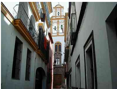
Figura 3. Paredes pintadas de branco numa rua estreita no bairro de Santa Cruz em Sevilha, em Espanha. Duas das muitas diferentes estratégias empregues na arquitectura tradicional para manter as casas frescas no verão.
