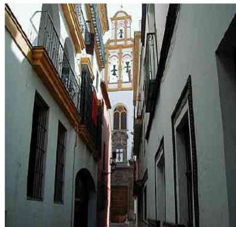
Figure 3 - Maisons blanchies à la chaux et rues étroites dans le quartier de Santa Cruz à Séville, Espagne. Deux des nombreuses stratégies utilisées par l'architecture traditionnelle pour conserver les maisons fraîches en été.
